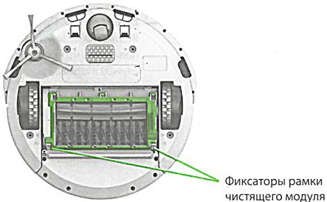
Фиксаторы рамки чистящего модуля
