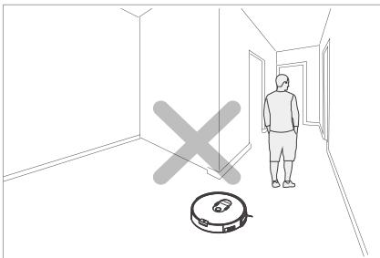
Не создавайте помех в узких проходах, а также на порогах, т.к. робот может пропустить эти места при уборке.
