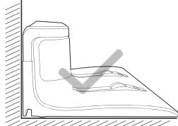
Установите док-станцию на ровной поверхности возле стены.
