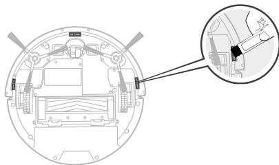
Очистите базу и гнездо подзарядки при помощи сухой ткани.
