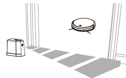
«Виртуальная стена», или «ограничитель движения», используется для того, чтобы не допустить перемещения робота в запрещенную зону. Разместите «виртуальную стену» в месте, где хотите заблокировать доступ роботу-пылесосу, например, за дверным проемом помещения:
