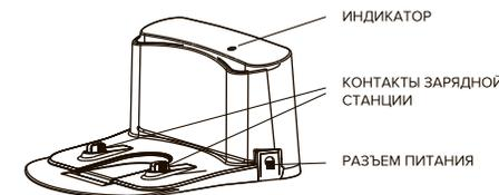
Используется роботом-пылесосом в качестве зарядной базы при завершении уборки или в случае низкого заряда аккумулятора. Робот самостоятельно обнаруживает станцию, реагируя на инфракрасный сигнал базы.
